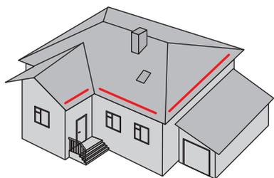
Элементы снегозадержания необходимо устанавливать на больших скатах для предотвращения лавинообразного схода снега с крыши, над входами в дом и въездами в гараж, на скатах, которые расположены над другими скатами, и для защиты водосточных желобов.
